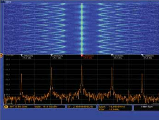
頻譜圖顯示說明緩慢變化的射頻現象。如圖所示，示波器正在監測擁有多個峰值的訊號。頻譜圖畫面很容易看到峰值的頻率與振幅隨時間變化情況。
