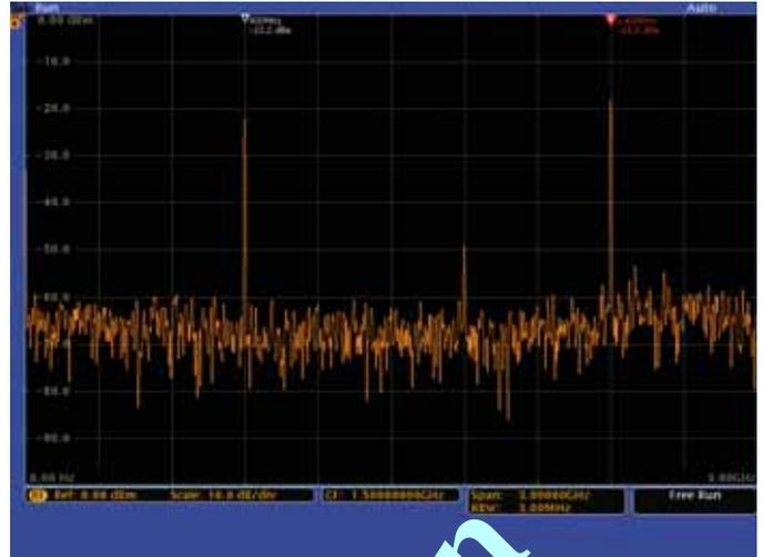
突波通訊的頻譜顯示，在 900 MHz 時透過 Z-wave 傳入裝置；在 2.4 GHz 時透過藍牙傳出裝置 (單次擷取中擷取)。
