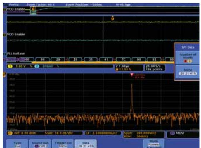
擷取 - 觸發整個 SPI 匯流排的特定傳輸資料封包。一套完整的觸發功能，包括觸發特定串列封包內容，確保您能迅速擷取到感興趣的事件。
