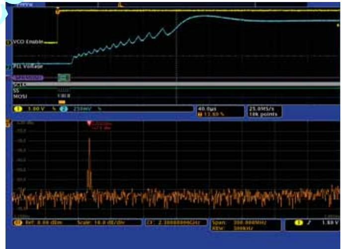
圖 1 顯示 PLL 啟動時的時域與頻域視圖。通道 1 (黃色) 正在探測啟用 VCO 的控制訊號。通道 2 (青綠色) 正在探測 VCO 調諧電壓。以所需頻率對 PLL 編程的 SPI 匯流排使用三個數位通道探測, 並自動解碼。注意到頻譜時間是在啟用 VCO 後設置, 與 SPI 匯流排上告知 PLL 所需 2.400 GHz 頻率的指令同步。請注意, 電路開啟時, 射頻為 2.2202 GHz。
