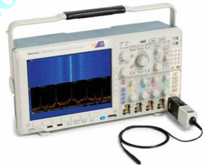
選配的 TPA-N-VPI 轉接器可將任意主動式 50 Ω TekVPI 探棒連接至頻譜分析儀。
