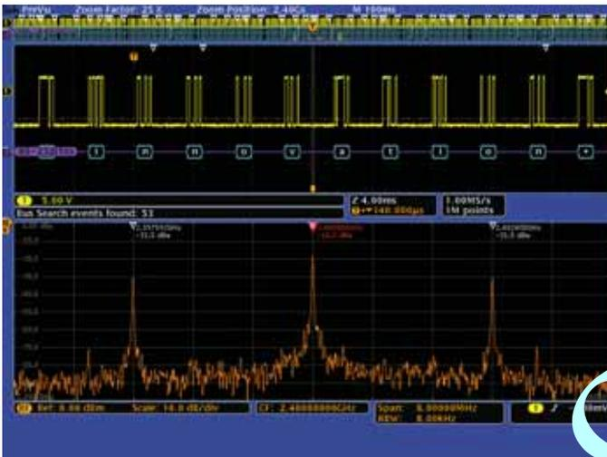
搜尋 – RS-232 的解碼功能，顯示 Wave Inspector 針對資料「值 n」的搜尋結果。Wave Inspector 控制項在檢視與瀏覽波形資料方面，提供前所未有的效率。
