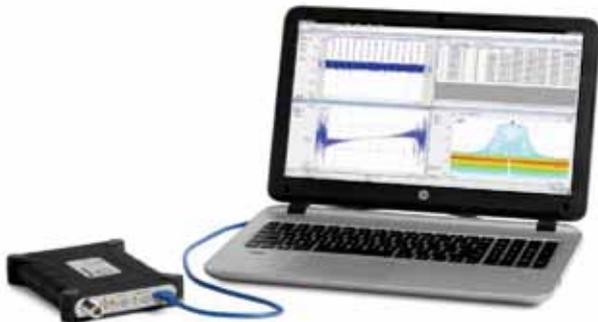
RSA306B 將使用您的 PC 和 Tektronix SignalVu®-PC 射頻訊號分析軟體, 在低成本、高可攜式套件中為 9 kHz 至 6.2 GHz 的訊號提供即時頻譜分析、串流擷取及深度訊號分析能力, 非常適合現場、工廠或學術用途。
