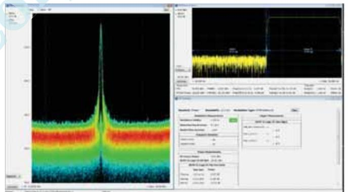
使用者可輕鬆進行精細的 WLAN 量測。在下圖所示的 802.11g 訊號上，頻譜圖顯示了初始的導頻序列，其次是主訊號資料組。調變會自動偵測為 64 QAM 的封包，並顯示為星狀圖。資料摘要會指示 -33.24 dB RMS 的 EVM，資料組功率則是在 10.35 dBm 進行量測。SignalVu-PC 應用程式可用於 802.11a/b/J/g/p、802.11n，以及 802.11ac 至 40 MHz 頻寬。
