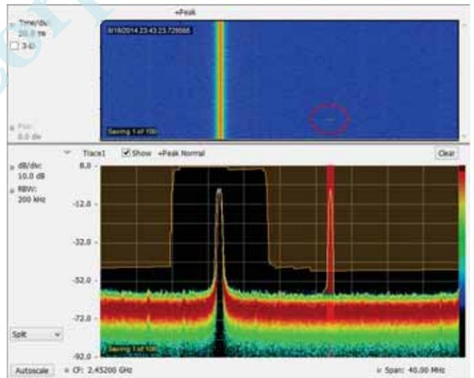
RSA306B 和 SignalVu-PC 讓您可輕鬆進行 EMI 預相容性和診斷量測。傳感器、天線、前置放大器和纜線增益/損耗可加入並儲存於修正檔案，而 SignalVu-PC 標準寄生量測功能可使用於建立您測試的極限線。下列圖示顯示 30 MHz 至 1 GHz 的測試，測試限制以綠色顯示。違反會記錄在圖形下方的測試結果表中。CISPR 峰值檢測和 -6 dB 濾波器頻寬為標準功能，提供您可與其他工具相比較的效果。
