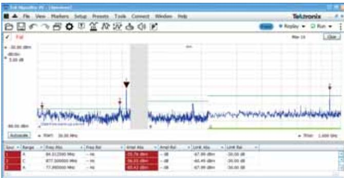
分析 AM 和 FM 訊號是 SignalVu-PC 中的標準功能。以下螢幕擷取畫面顯示了 1 kHz 音調振幅將載波調變為 48.9% 的總 PM。頻譜顯示上會使用標記來量測的調變旁波帶（從載波偏移 1 kHz，下降 12.28 dB）。調變顯示中可同時檢視相同的訊號，顯示 AM 與時間，以及 +峰值、-峰值和總 AM 量測。選配 SVA 提供了類比音訊調變的進階量測功能，包括 SINAD、THD 和調變率。
