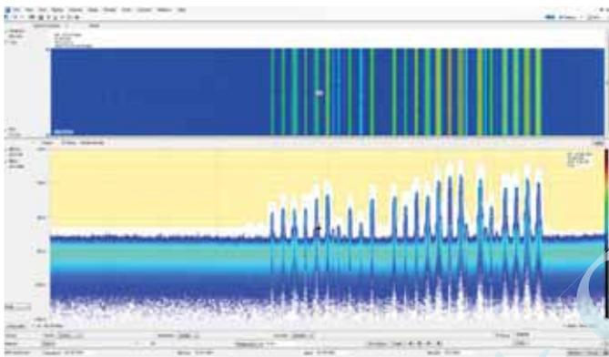
訊號分類應用程式 (SV54) 可讓您製作專家級的系統指引，以協助使用者分類訊號。它提供的圖形工具可讓您在短時間內建立目標頻譜區域，因而能有效率地分類和排序訊號。將頻譜輪廓遮罩重疊放置在軌跡上時，可在顯示頻率、頻寬、通道號碼及位置的情況下提供訊號形狀指引，進而快速檢查。可快速及輕易的分類 WLAN、GSM、W-CDMA、CDMA、藍牙標準和 Enhanced Data Rate、LTE FDD 和 TDD 及 ATSC 等訊號。可從 H500/RSA2500 訊號資料庫匯入資料庫，以輕鬆進行新軟體基礎的轉換。
