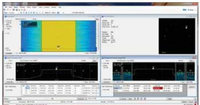
播放已記錄的訊號的功能可大幅縮短您檢視記錄資料時，觀看和等待發現頻譜違反的時間。記錄長度僅受限於儲存媒體的大小，且記錄功能是包含在 SignalVu-PC 的基本功能。SignalVu-PC 應用程式 SV56 播放可讓您透過所有 SignalVu-PC 量測進行完整分析，包括 DPX 頻譜圖。播放時會維持最小訊號持續時間規格。可執行 AM/FM 音訊解調。變數頻距、解析度頻寬、分析長度以及頻寬皆有提供。可在高達 40 MHz 頻距的已記錄訊號上進行頻率遮罩測試，並可針對遮罩違反執行嗶聲、停止、儲存軌跡、儲存圖像和儲存資料等動作。可選取並循環播放部分的播放，重複測試目標訊號。播放可為不間斷，或插入時間差距以縮短檢視時間。即時率 (Live Rate) 播放確保了 AM/FM 解調的保真度，並提供播放和實際時間 1:1 的比例。記錄的時鐘時間顯示為頻譜圖標記，以與真實事件建立關聯。在下方圖示中，正在重播 FM 頻帶，並套用了遮罩以偵測頻譜違反，同時監聽 92.3 MHz 中心頻率的 FM 訊號。
