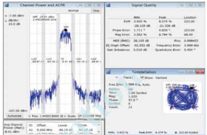
SignalVu-PC 應用程式 SV26 可在 APCO P25 訊號上進行快速的標準式發射器運作狀況檢查。下圖顯示在執行發射器功率、調變和頻率量測時，使用頻譜分析儀監測相位 II 訊號是否異常。
