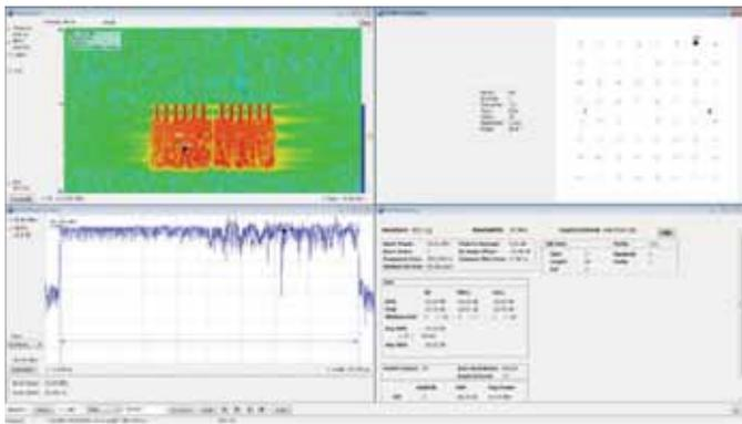
若搭配應用程式 SV27，您可以在時域、頻域和調變域中執行藍芽 SIG 標準式發射器 RF 量測。這個應用程式可支援 Basic Rate（如藍芽 SIG 測試規格 RF.TS.4.1.1 所定義）和 Low Energy（如 RF-PHY.TS.4.1.1 所定義）發射器量測。應用程式 SV27 也能自動偵測 Enhanced Data Rate 封包、進行解調，並提供符號資訊。為求標示清楚，符號表中的資料封包圖場採用彩色編碼。
