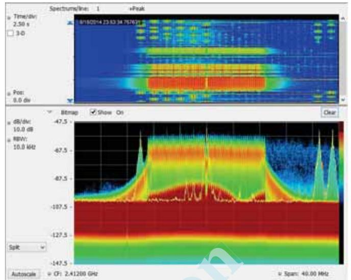
監測從未如此簡單。使用者可在頻率域中找到暫態訊號的頻譜遮罩測試擷取細節，如間歇性干擾。遮罩測試可設定為停止擷取、儲存擷取、儲存圖片和傳送可聽警報。下圖顯示所建立的頻譜遮罩（頻譜顯示上的橘色部分）以監測一群違反的頻率。125 μs 的單暫態訊號已出現違反遮罩，圖上是以紅色來顯示違反部分。在頻譜圖的紅色違反區域（圓圈）上清楚地顯示了暫態訊號。
